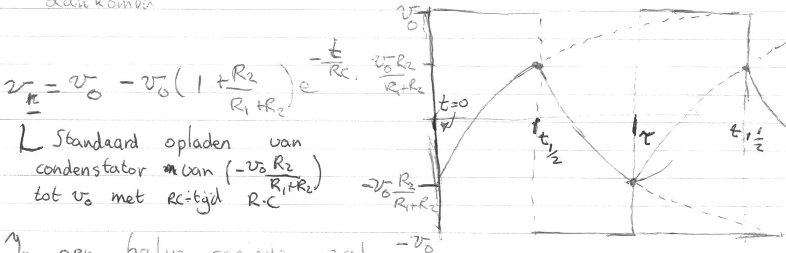
$$v_- = v_0 - v_0 \left(1 + \frac{R_2}{R_1 + R_2}\right) e^{-\frac{t}{RC} \frac{v_0 R_2}{R_1 + R_2}}$$
